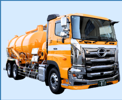
清掃車（強力吸引作業車）：15台
